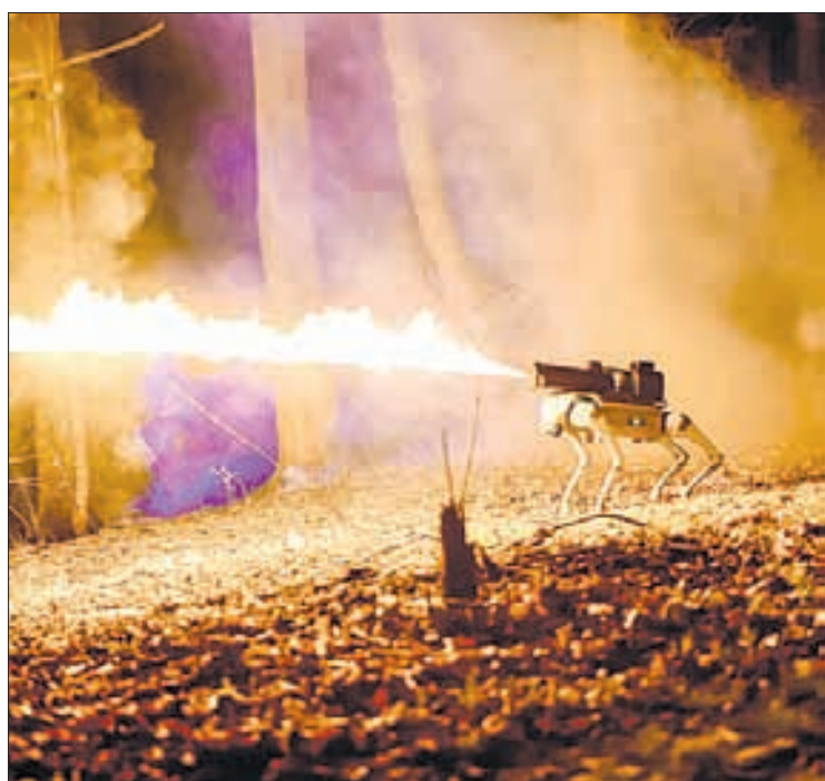
▲ Thermonator utiliza gasolina o napalm y su batería dura una hora. Foto tomada de la página de Ars Technica
